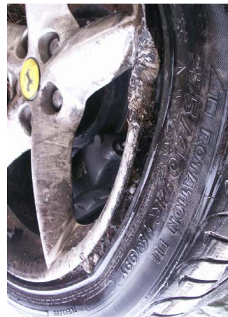
Figur 2 Inpressat grus och asfaltkantjack i vänster bakhjul visar att däckets var så gott som punkterat då det sladdade av asfalten. Nesmark 6 bortser helt även från detta fynd. Foto nr 1135 i Bilaga B 14 , se även 1187 m.fl.
