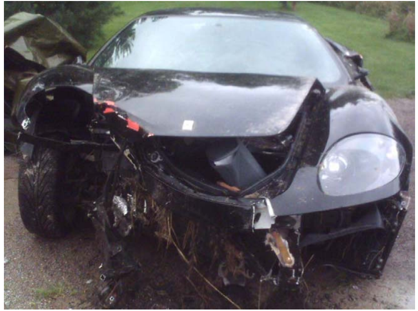
Figur 5 Olycksbilens fronskada, vars ursprung ej förklaras i rapporten 6 av Nesmark. Den tvära sväng som krävs för att nå trädet T (enligt Figur 4 och Figur 1) är ogenomförbar med de höga avåkingsfarter, som Nesmark utgått från. Inte ens föraren TW hade kopplat fronskadan till trädet T, när han visade mig olycksplatsen 4-5 oktober 2006.
