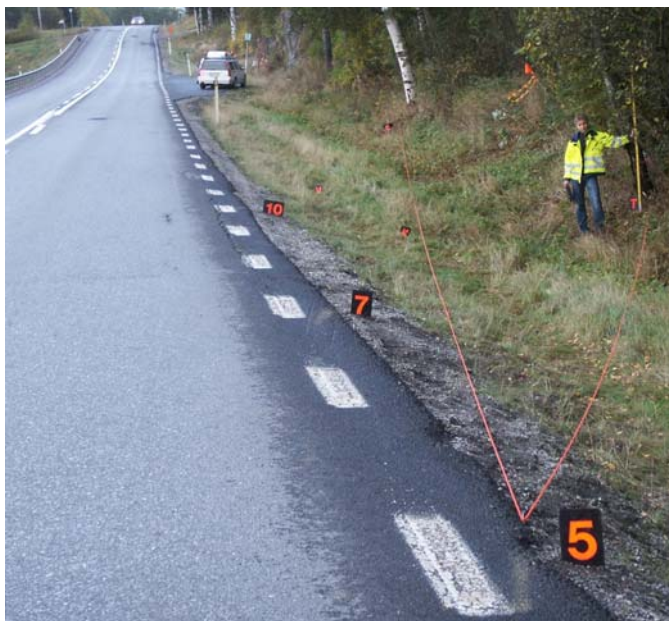
Figur 1 Enligt Nesmark 6 sladdade bilen av vägen i minst 135 km/h med högerhjulen nära kantlinjerna 5&7 (K5&K7) mot vita trädet C . Men mina fynd omkring trädet T i höger bildkant visar på en så tvär gir att Nesmarks överdrivna fartuppgift och rekonstruktion helt falsifieras. Foto nr 1288 (obeskuret och med större upplösning i Bilaga B 14 ).
