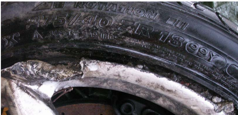
Figur 8 Olycksbilens vänstra bakhjul med slitagejacket i fälgen och inklämt grus, som torde härröra från moment B5 i Figur 9 - när punkteringen gör att däcksidan ger vika så att fälgen slipas ur mot asfaltkanten och grus från vägbanken kläms in i hjulet. Den stora avdriftsvinkeln (>45° enligt Figur 9) bekräftas av jacketets form. [1137] 14
